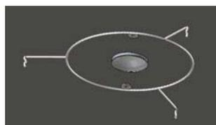
fixation de la carcasse métallique au plafond
